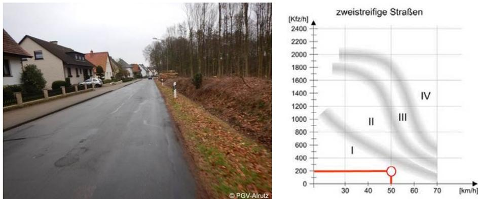
Abb. 6-29: Am Haupthügel – scharfe Abbruchkanten und eingeschränkte Belagsqualität (links), Auswahl der Radverkehrsanlage anhand DTV nach ERA 2010 (rechts, Quelle: ERA 2010)
