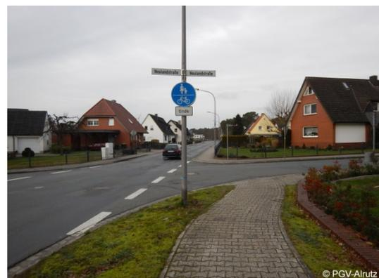
Abb. 6-23: Hansastrasse – Verschwenkte Radverkehrsfurt (links) und abruptes Radwegeende (rechts)
