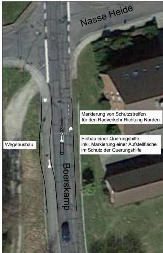
Abb. 6-26: Boerskamp – Prinzipskizze für Einrichtung einer Mittelinsel
