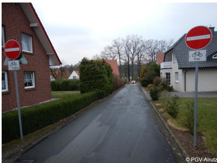
Abb. 6-22: Für den Radverkehr in Gegenrichtung geöffnete Einbahnstraße (Rulle, Höhenweg)
