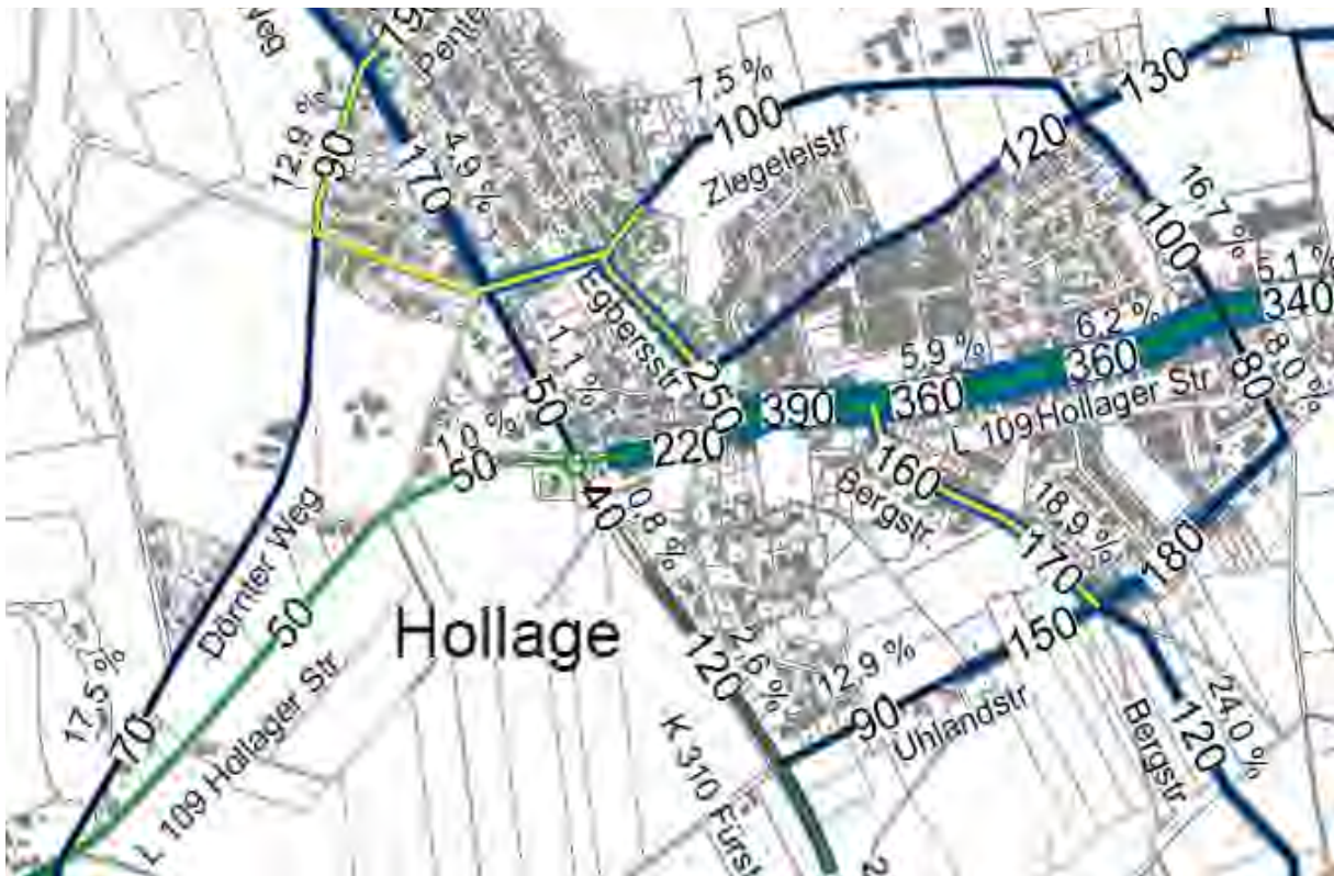
Abb. 9 | Radverkehrsmengen (Räder/24h) und Anteil am Gesamtverkehr, 2014
